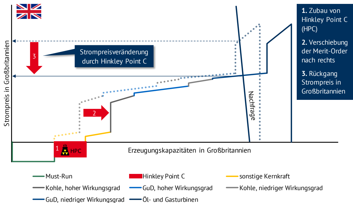
Abbildung 6: Qualitative Darstellung des Merit-Order-Effekts durch Hinkley Point C in Großbritannien (Prinzipbild mit überzeichnetem Effekt)
